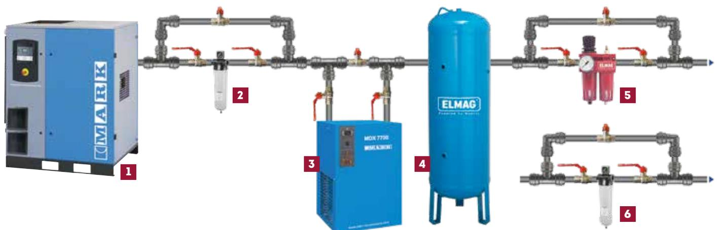
Schematisches Beispiel für die Komponenten-Bauweise einer Druckluft-Versorgungsanlage mit Schraubenkompressor (1), Zyklonabscheider/Vorfilter (2), Kältetrockner (3) und Speicherbehälter (4).
