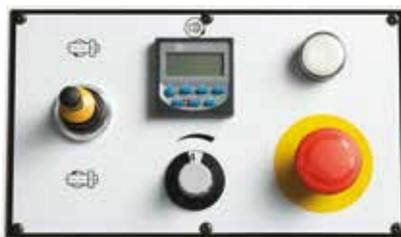
Mitfahrendes Steuerpult mit Drehspindel R/L-Steereinheit, digitaler Drehzahlanzeige, Vario-Speed-Drehzahlregelung, Betriebslampe und Not-Aus-Taster
