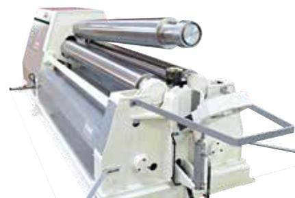
Das Ausklinken der Oberwalze erfolgt hydraulisch.
