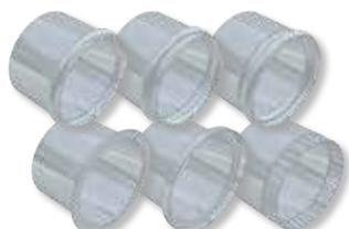
Beispiele für Sicken-, Bördel- & Einziehprofile
