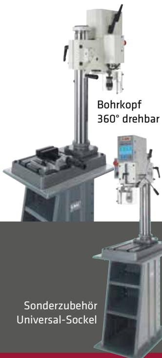
Bohrkopf 360° drehbar
