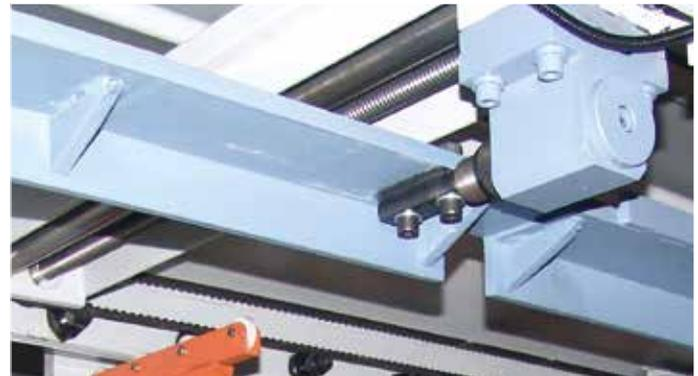
NC-gesteuertes Hinteranschlagesystem für automatische Positionierung und Rückstellung über Kugelumlaufspindel
