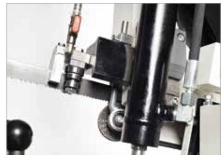
Späneabstreifer aus Hartmetall, direkt angeschlossenes Kühlmittelventil, präzise einstellbare Doppelspannlager, einstellbarer Späneabstreifer - BAUER Bandsägen bieten bis ins Detail eine sehr gute Verarbeitungsqualität.
