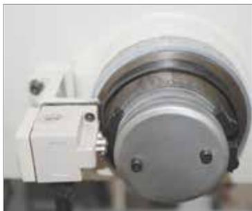
Gewindeschneideinrichtung mit Drehrichtungsumkehr ab KSBM 5/63:
