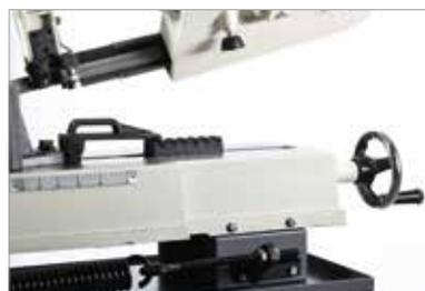
Schnellspannschraubstock mit Distanzhalter und Einstellskala
