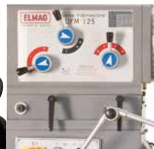
UFM 125 Spindelgetriebe mit Schnellschaltelementen
