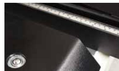
Auflagetisch mit Kugellrollen für mühelose Blechpositionierung
