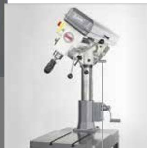
Ausleger stufenlos ± 90° schwenkbar
