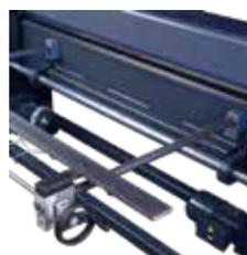
Manueller Hinteranschlag mit Zähler
