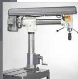
Ausleger stufenlos ± 180° drehbar
