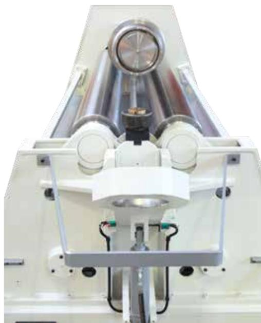
Hydraulisch betätigtes Gegenlager
