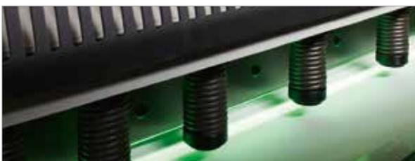
Automatisches Niederhaltersystem und Schnittlinienbeleuchtung
