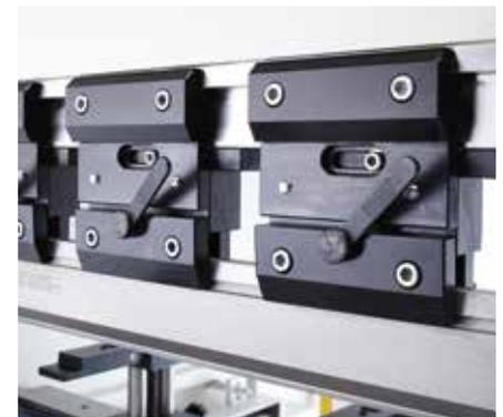
Oberwerkzeughalterung mit Schnellwechselsystem
