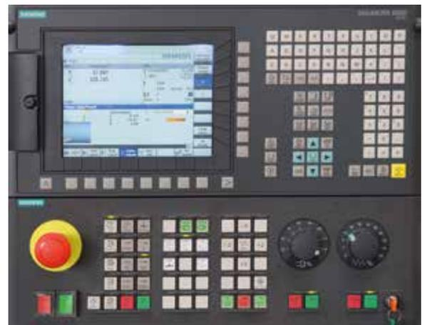
Steuerpanel SIEMENS SINUMERIK 828D
