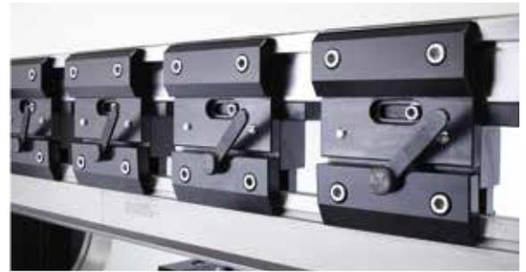
Oberwerkzeughalterung mit Schnellwechselsystem
