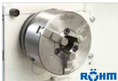
Hochwertiges RÖHM Dreibacken-Drehfutter aus Stahl
