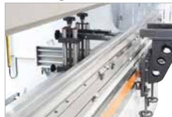
Rasch verstellbare Auflagearme mit Lineal und T-Nut
