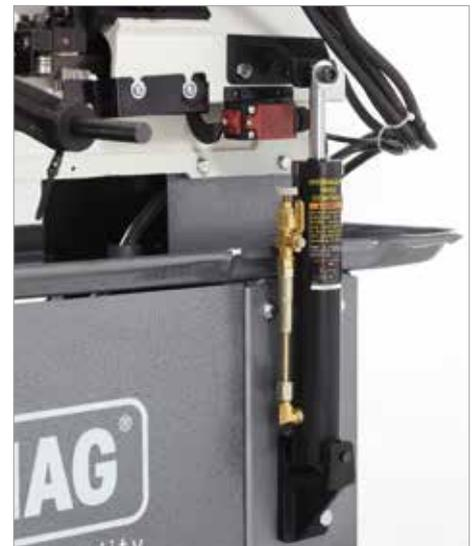
Absenkautomatik für stufenlose Vorschubeinstellung - mit Hydraulikzylinder, angebautelem Regelventil mit Drehregler und integriertem Absperrventil
