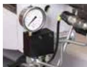
Spanndruckregelung des Spannstockes
