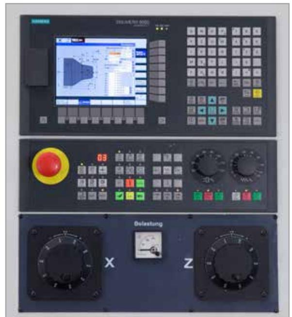
Steuerpanel mit 2 elektronischen Handrädern
