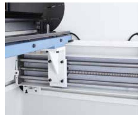
Präzise Positionierung des Hinteranschlags durch Kugelumlaufspindeln
