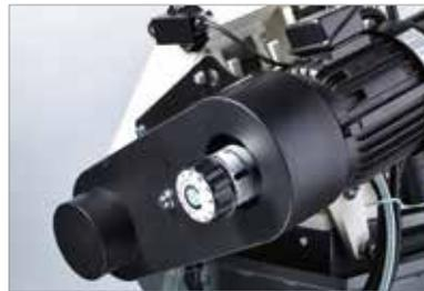
Stufenlos einstellbarer Schnittgeschwindigkeitsregler mit 12 Einstellbereichen 0-11 und Bandgeschwindigkeitsanzeige
