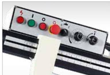
Steuerpanel mit Betriebslampe, Start-, Stopp-, Not-Aus-Taster, Kühlmittelpumpe O/I, Absenkautomatik mit Regelventil 0-10 und Absperrventil ON/OFF
