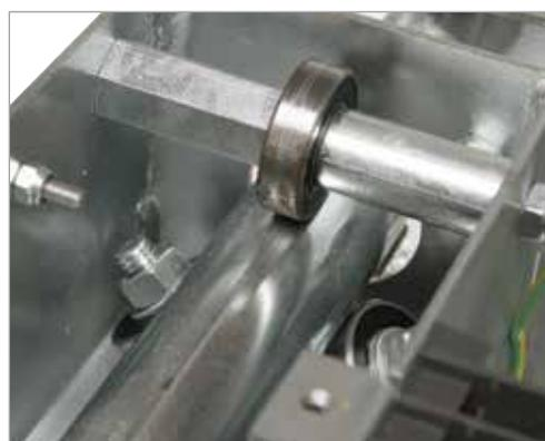
Schau genau: Vielfache Lagerung der präzisen, nachjustierbaren Rollschlittenführung bei FSM- und STM-Modellen. Die Lageranzahl entscheidet über die Präzision von Längsschnitten.
