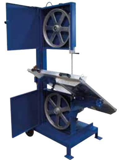
Sägebandwechsel in kürzester Zeit möglich. Die Maschine stoppt sofort wenn eine der Türen geöffnet wird.
